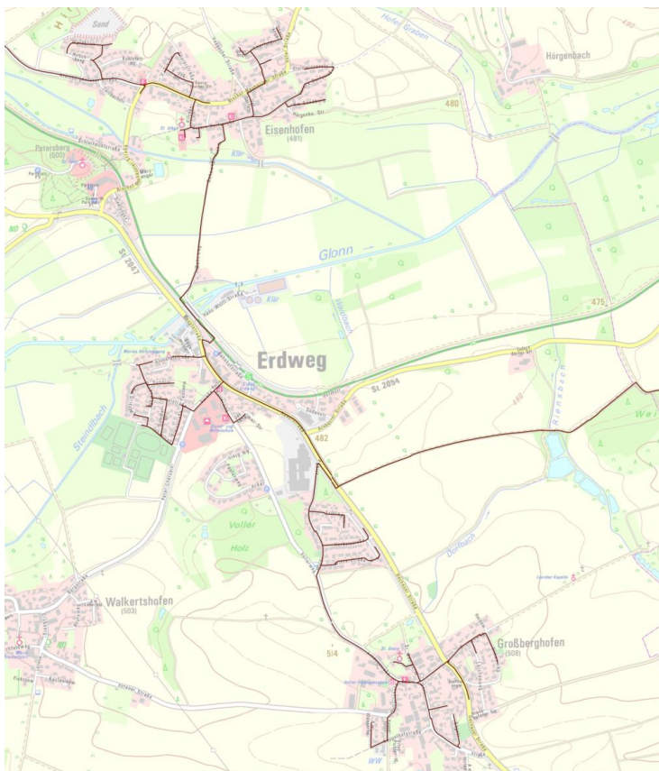
Abbildung 64: Erdgasnetz Kommune Erdweg (Teil 1/2), Quelle: Energienetze Bayern
